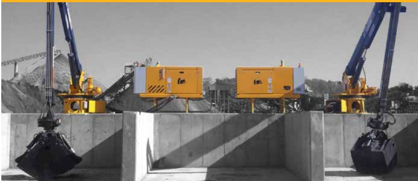
SM-H Unité de puissance : à distance | Poste de commande : sur la chargeuse
